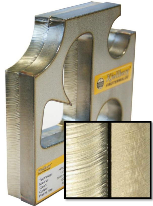
10 mm-es rozsdamentes acél víz alatti és száraz vágásának összehasonlítása
